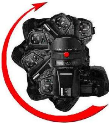
Tutto il sistema di ripresa deve ruotare intorno al punto nodale dell'obiettivo e non sull'asse di montaggio della fotocamera sullo stativo.
